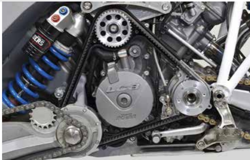
In die Vollen: Von der KTM 990 Adventure finden sich nur Motor und Hinterradschwinge wieder. Die Achsschenkellenkung ist die logische Konsequenz des Vorderradantriebs über eine Schwinge
